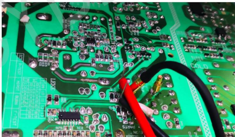
图 8 测量驱动波形接头连接示意图
